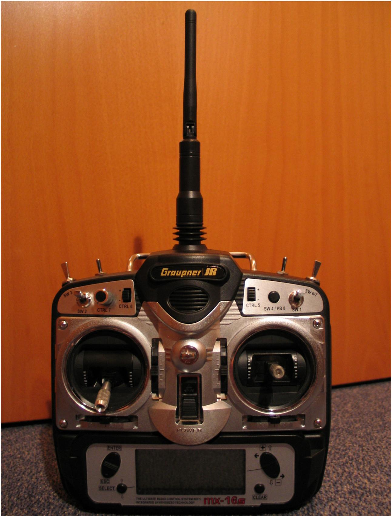
Bild 11 – fertiger MX-16s Umbau auf 2.4Ghz
