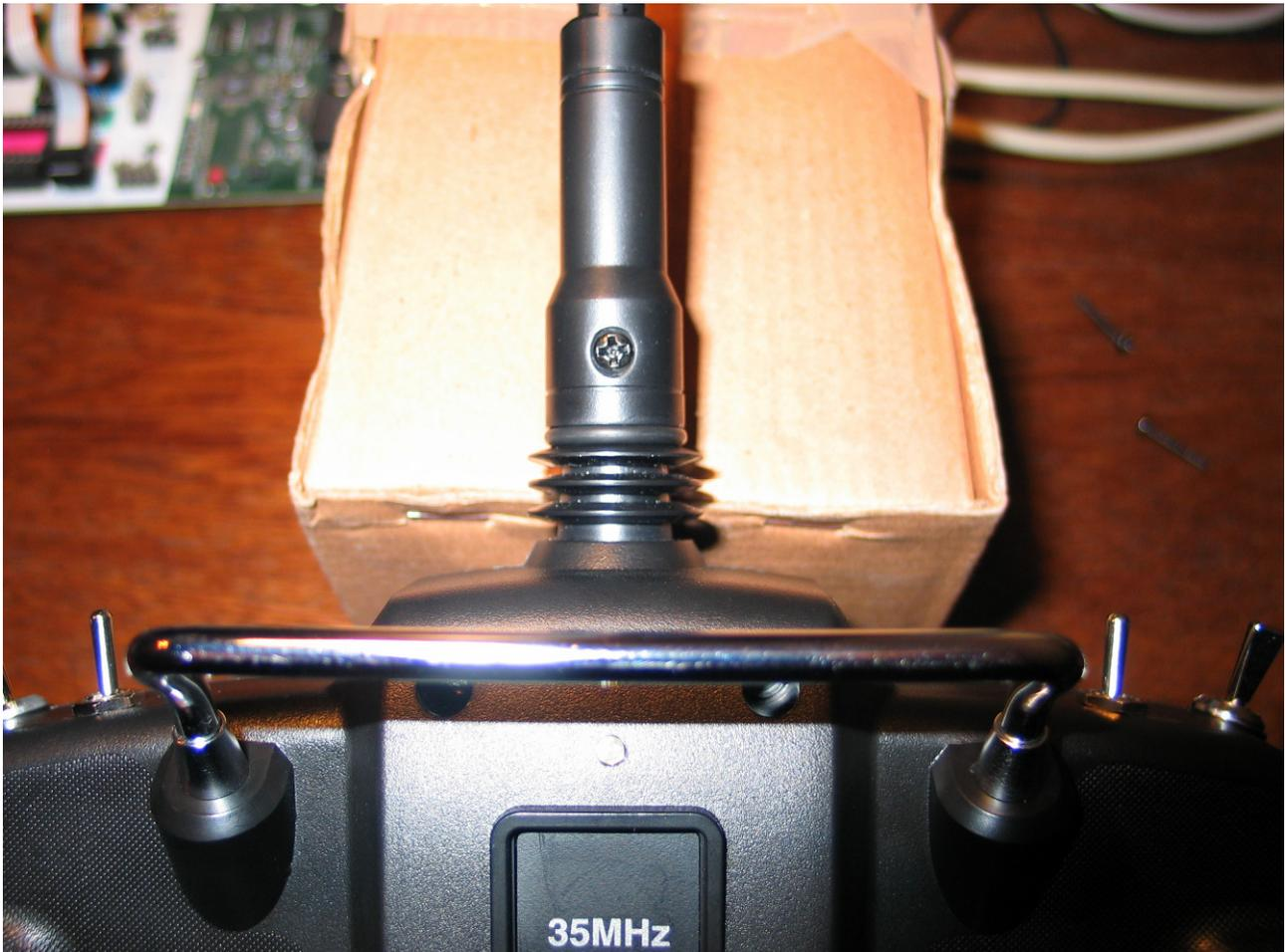
Bild 10 – Detailansicht des Gummirings, der die Antenne fixiert. Ebenfalls sind die beiden Kippschalter (Rechts: DSC Modus / 2.4Ghz Modus, Links: Bindtaster, Gehäuse-Mitte: Signal-LED) zu sehen.
